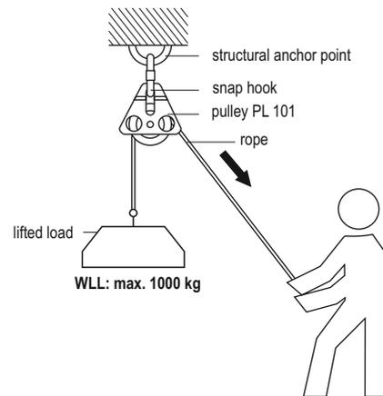
**USE OF PULLEY PL101 AS ELEMENT OF RESCUE LIFTING SYSTEM**
