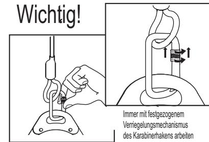
Ein fester Verankerungspunkt, an den die Seilschlinge angeschlossen wird, soll sich oberhalb des Einsatzbereiches befinden und seine Form und Konstruktion sollen selbsttätiges Lösen des Seils ausschließen. Mindestatische Festigkeit des Verankerungspunktes beträgt 30 kN.
