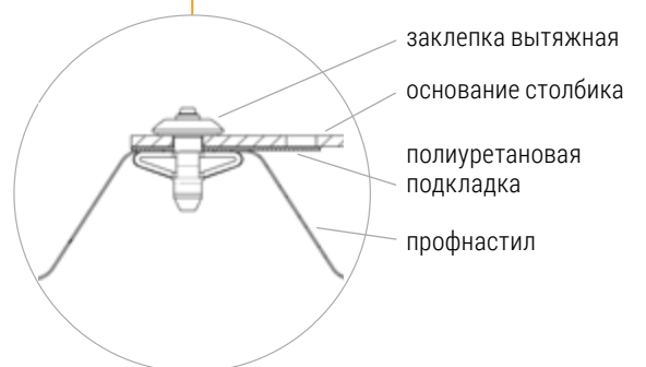
монтаж столбика HL 760 на фальцевую кровлю
