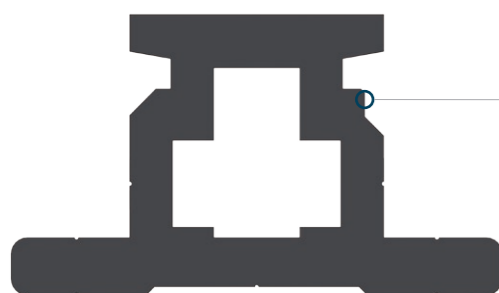
Przekrój poprzeczny prowadnicy szynowej
